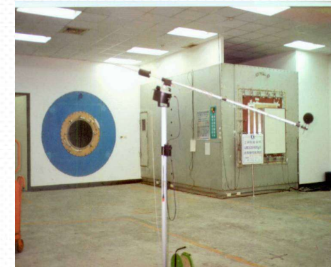
AMCA Fig.15/ISO Fig.40(e) 最大風量1000cmm 最大出口尺寸1.42m×1.42m
