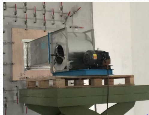
AMCA Fig.12/ISO Fig.41 最大風量3000cmm 最大測試尺寸1.15m
